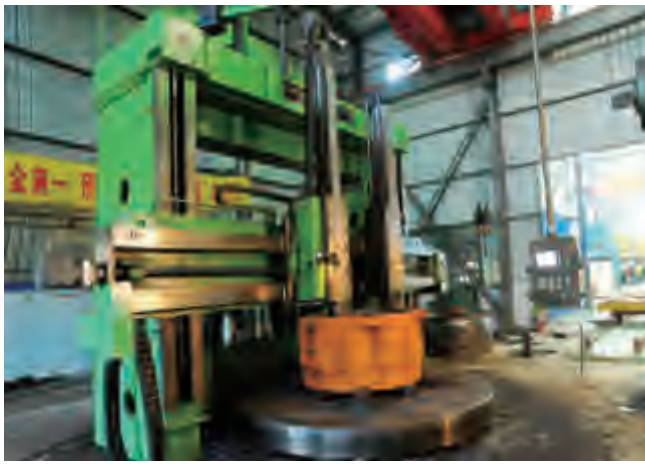
具有德国西门子 802DS 电气系统的 Q (X) 5240 数控双柱立车 Q (X) 5240 CNC double column vertical lathe equipped with German Siemens 802DS electrical system
